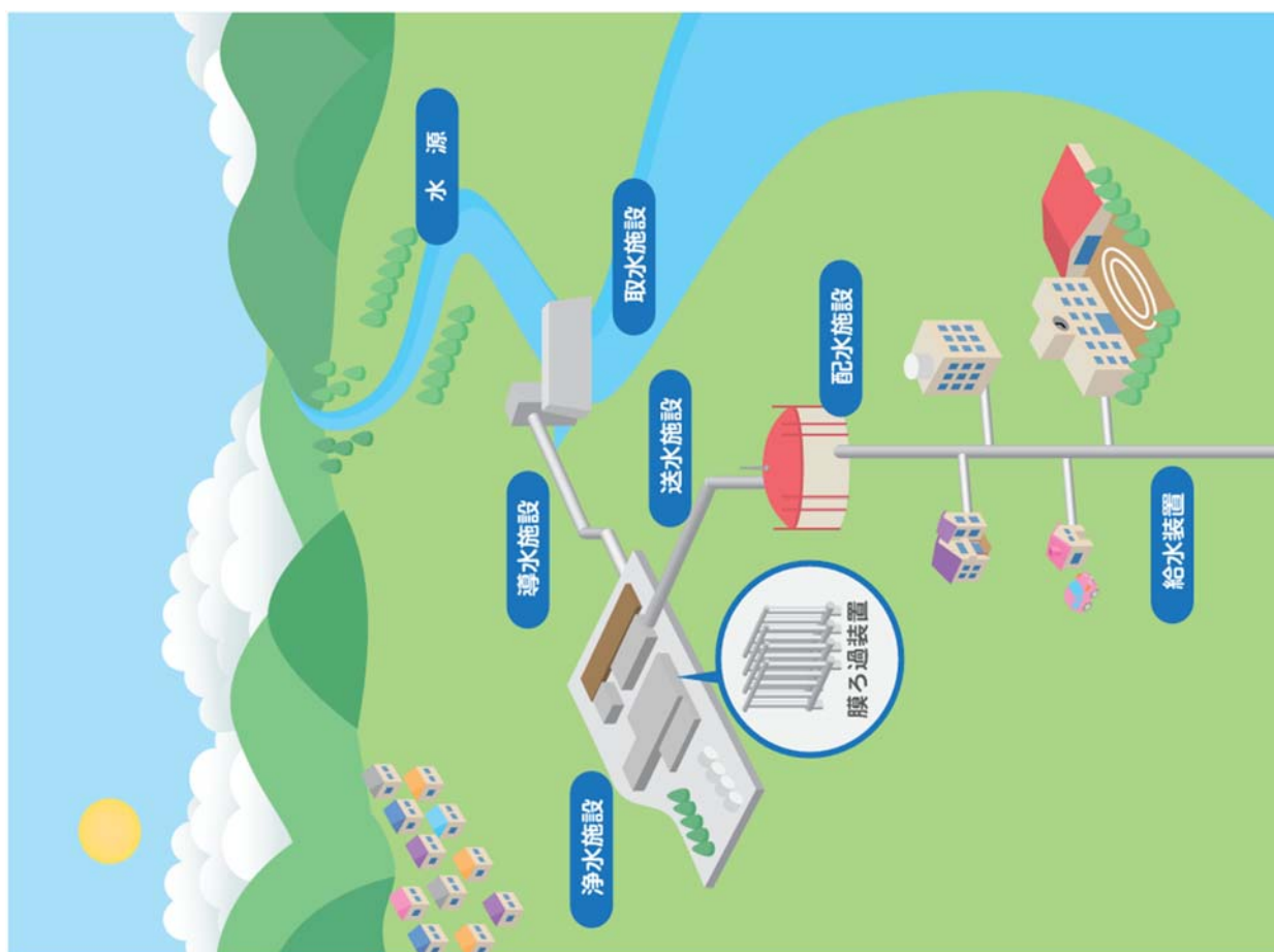
図-3.2.1 水道水ができるまでの全体工程図
