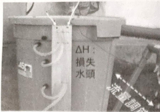
図24 バケツモデルで損失とろ過速度の関係を解説した
